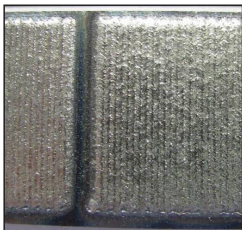
Покрытие CFS 4041 после наплавки
