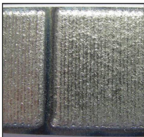
Покрытие CFS 4041HS после наплавки
